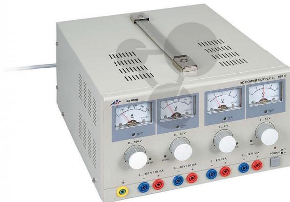
Particulièrement adaptée à l'alimentation des tubes électroniques, notamment des bobines de Helmholtz, avec quatre tensions continues à réglage indépendant et affichages analogiques. Les tensions continues sont stabilisées et régulées, isolées de la terre, pourvues d'une séparation galvanique et résistent aux courts-circuits et aux tensions externes.
