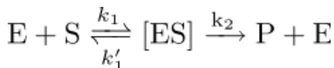
Das Modell besagt, dass mit steigender Substratkonzentration auch die Reaktionsgeschwindigkeit steigt. Das geschieht anfangs linear und flacht dann ab, bis eine weitere Steigerung der Substratkonzentration keinen Einfluss mehr auf die Geschwindigkeit des Enzyms hat, da dieses bereits mit Maximalgeschwindigkeit  $V_{max}$  arbeitet. Die MM-Gleichung lautet wie folgt:
