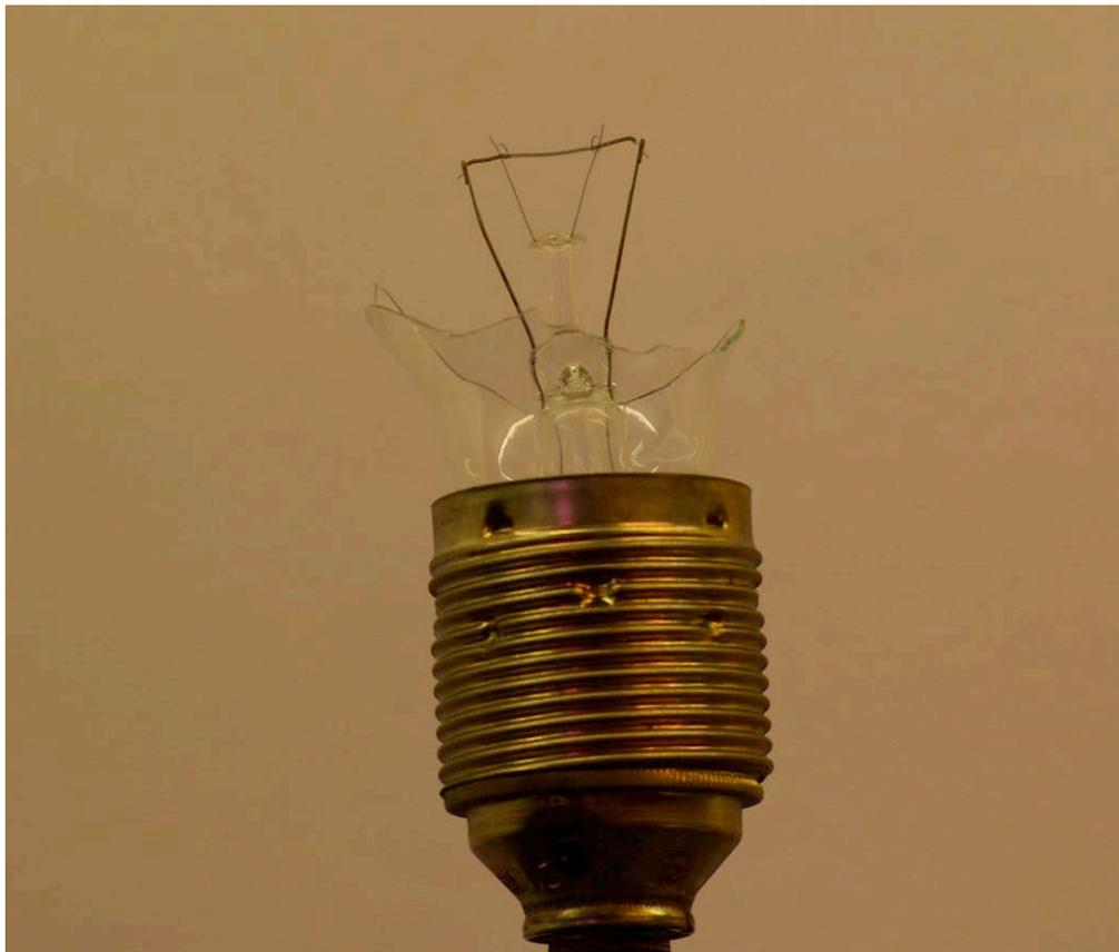
d. Eine Glühbirnenruine ( mit intakter Glühwendel ) wird in die Fassung eingeschraubt (Vorsicht!! Schalter vorher auf AUS sowie Verletzungsgefahr beim Ein - und Ausschrauben !) Wechselstrom
