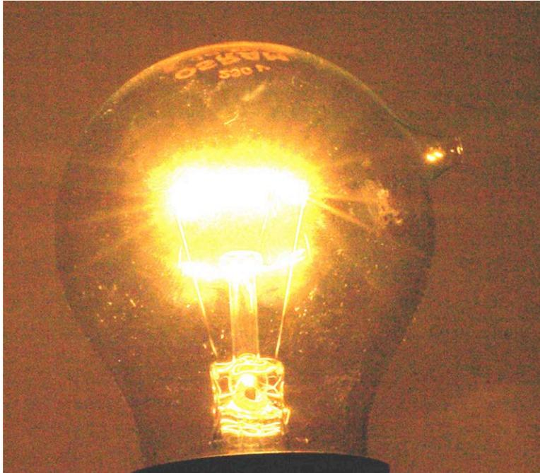
Im Bild rechts oben: Die Ausstülpung des Glaskolbens der Glühbirne nach dem Erhitzen mit Loch
