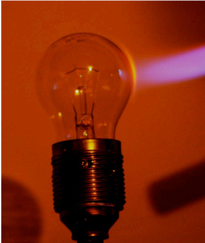
Im Bild: Schatten rechts unten entspricht dem Bunsenbrenneroberteil; blauer Bildanteil von schräg rechts oben ist die blaue Bunsenbrennerflamme. Das Glas der Glühbirne beginnt bereits zu glühen.
