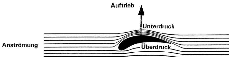
Dieser Auftrieb hält den Vogel in der Luft oder bewirkt sein Steigen in größere Höhen. Wichtig ist zu wissen, dass dieser Auftrieb besonders wirksam und besonders gut zu beobachten ist bei dem **Gleitflug**-Verhalten von Vögeln (Möwen u.a. Seevögel, Taggreife u.a. mehr), dass aber bei diesen Gleitflügen auch die Thermik, also Aufwinde, eine wichtige Rolle spielen.
