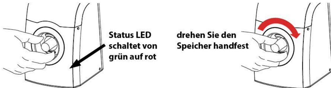
Solange die Status LED rot leuchtet, erfolgt die Befüllung des Wasserstoffspeichers. Der Befüllungsvorgang ist beendet, wenn die Status LED grün leuchtet. Nun können Sie den Wasserstoffspeicher entgegen dem Uhrzeigersinn herausdrehen.
