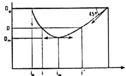
Hierdurch wird es auch ermöglicht, die Brechzahl n, ausgehend von A und Dm (experimentell bestimmt) zu berechnen.
