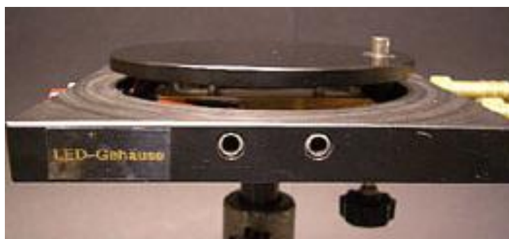
Abb. 6 Anschlüsse für die steckbare LED-Beleuchtung
