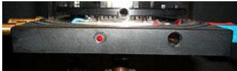
Abb. 4 Warn LED (Überhitzungsschutz) und Bohrung für die Temperatur Messung
