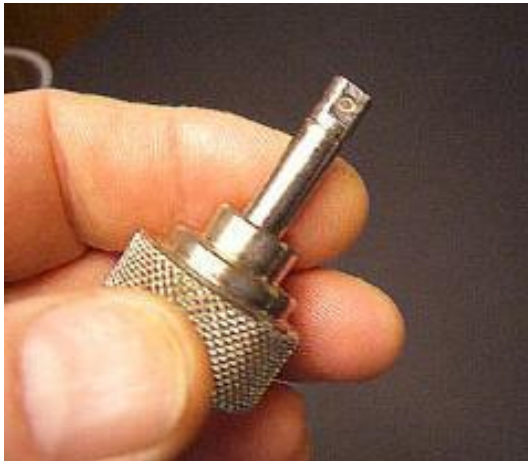
Abb. 3 Einbringen eines Strahlerstiftes in die Nebelkammer
