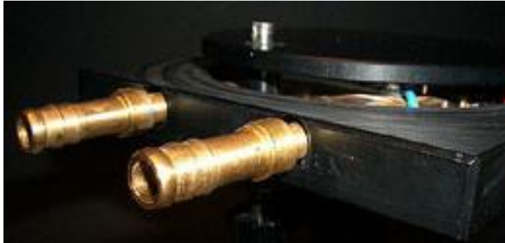
Abb. 7 Anschlüsse für den Kühlwasserkreislauf
