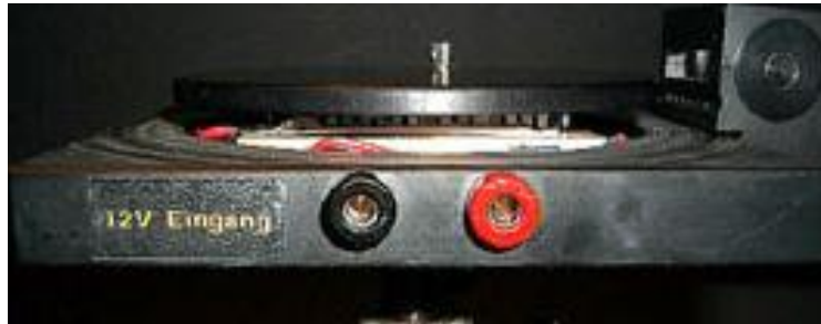
Abb. 5 Anschlüsse für die Versorgungsspannung von 12-15V / 8A
