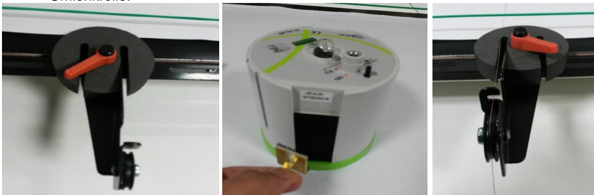
Abbildung 10: Umlenkrolle an der Tischhalterung befestigen. Ansatzstück mittels Klettverschluss zur Befestigung am Gleiter. Aufbau des Gesamtaufbaus.
