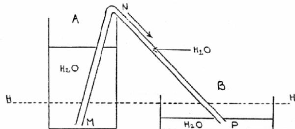
Die beiden Oberflächen bilden kein einheitliches Niveau. Das Glasrohr MNP wird vorher mit Wasser gefüllt. Wir beobachten, daß ein Gleichgewicht hergestellt wird und das Wasser sich auf der gleichen horizontalen Ebene H H' stabilisiert. Das Rohr MNP stellt einen Siphon dar.
