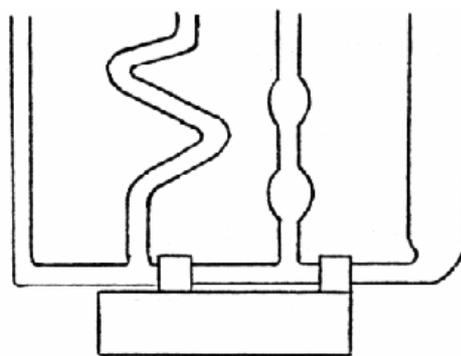
Wenn mehrere offene Gefäße die gleiche Flüssigkeit enthalten und wenn sie untereinander in Verbindung stehen, dann zeigt es sich im Laufe des Experimentes, daß sich alle Flüssigkeitsspiegel auf der gleichen horizontalen Ebene einpendeln.
