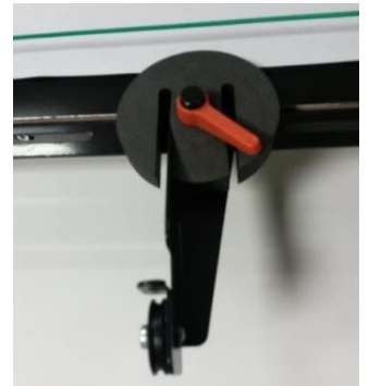
Poulie déportée montée sur l'une des cornières de la table fournie (vue de dessus)
